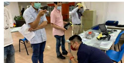
過濾面體式口罩、半面式呼吸防護具之定性密合度測試
